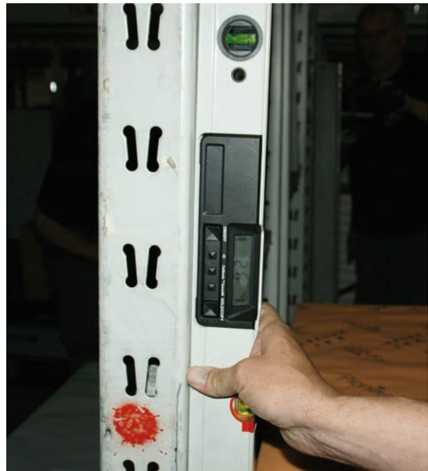
Abb. 10: Messung der Schiefstellung mit digitaler Wasserwaage
