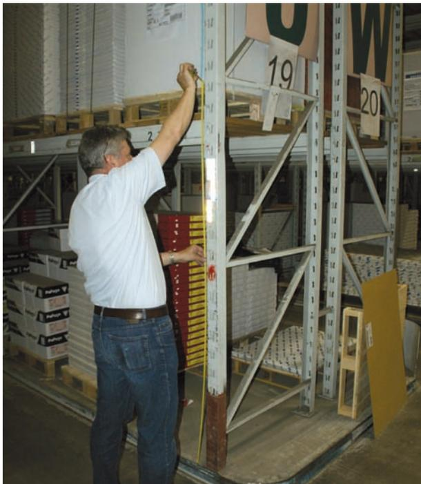
Abb. 6: Überprüfung der Fachhöhe
