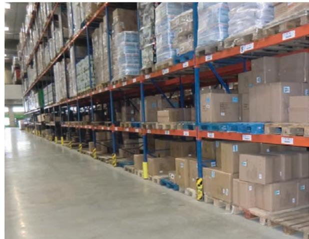
Abb. 19: Stützenschutz an allen Stützen
