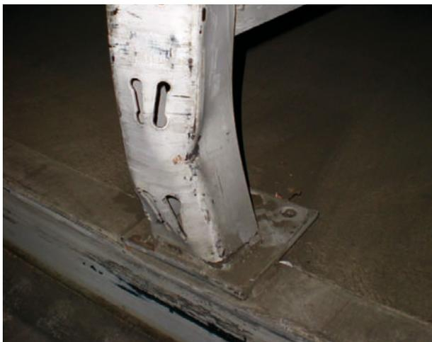
Abb. 12: Gerissene Schweißnaht an der Fußplatte der Stütze
